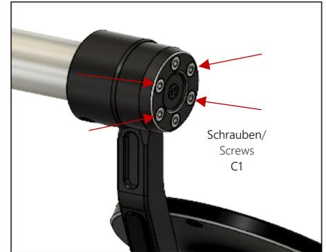
7) Ziehen Sie die Schrauben (C1) und (C2) fest an (max. 3Nm), sobald Sie den Spiegelarm korrekt eingestellt haben. **Achten Sie darauf, dass der Blinker senkrecht zum Boden und nach vorne in Fahrtrichtung positioniert ist, damit die Ausleuchtung ECE-konform geschieht.**
